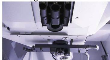
Späneschutz- Türe verhindert das Eindringen von Spänen
