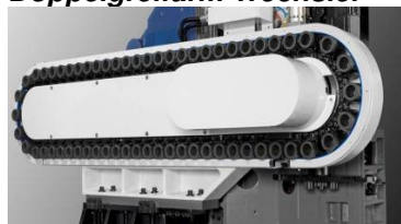
Bidirektional für schnelles vorwählen des nächsten Werkzeuges.
