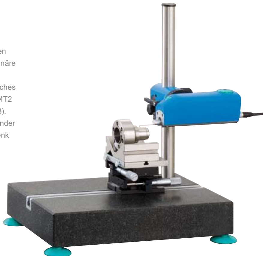
Motorische Tasterabsenkung zur automatischen Positionierung
