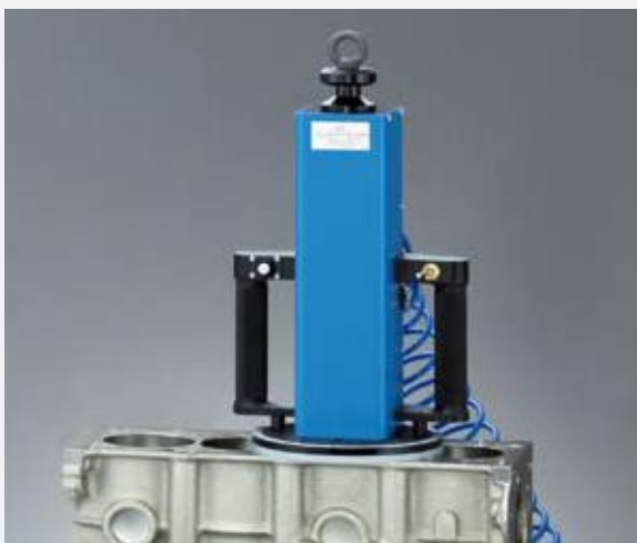
Messdorn zur Rauheitsmessung in Zylinderbohrungen mit pneumatischer Spannvorrichtung
